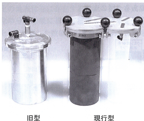
写真3 小型反応容器 現行型の反応容器は、左側に燃料のMgH 2 を、右側にクエン酸溶液を入れる。PICによるプログラム制御により、水素発生装置と燃料電池が総合的に制御される。旧型は、クエン酸溶液を外部から手動またはシーケンサー制御により供給し、水素ガスを発生させた。
